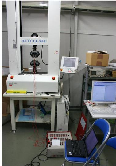
図7 樹脂/高強度Mg合金二層積層材の引張試験の様子
