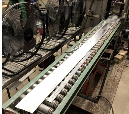
図1 急凝固Mg合金製造プロセス
